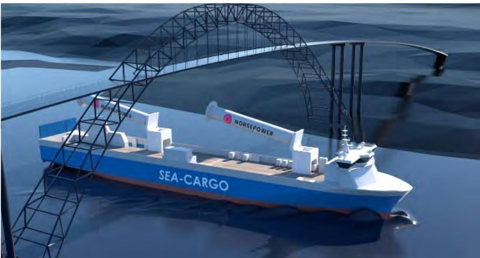
Norsepower, una empresa finlandesa que fabrica sistemas de propulsión eólica auxiliar, concretó un acuerdo para instalar las primeras velas de rotor inclinables del mundo a bordo del SC Connector, un buque de carga Roro de puerta lateral de la compañía Sea Cargo.
